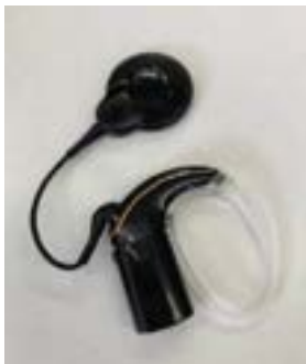
←人工内耳 体外部 (送信コイル、サウンド プロセッサー、電池)
